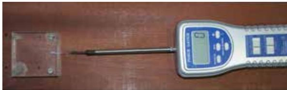
Figura 1 – Sistema montado para avaliação das forças liberadas.
