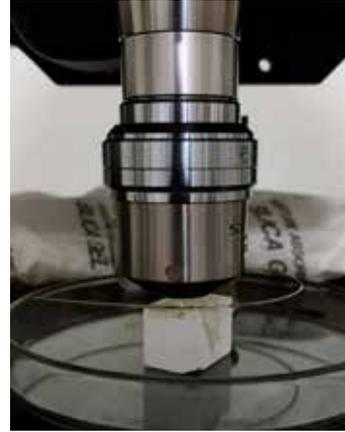
**Figura 6** – Fio sobre a base de zircônia sendo avaliado por perfilômetro.
