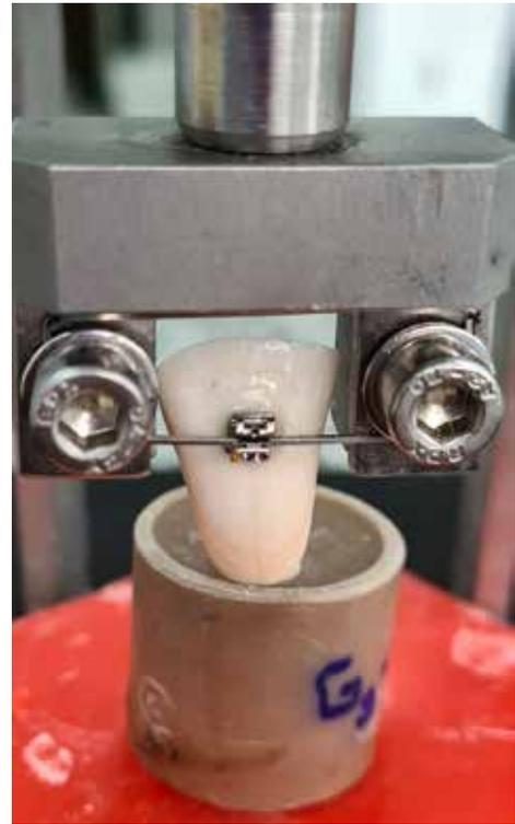
**Figura 4** – Equipamento para posicionar de forma padronizada a inclusão dos dentes ao tubo de PVC, a fim de manter o bráquete perpendicular à máquina para o teste de cisalhamento.
